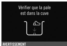
**Avant de passer à la liste d'ingrédients**, un signal sonore et un nouvel écran apparaissent afin de vérifier si la pale est bien dans la cuve.
